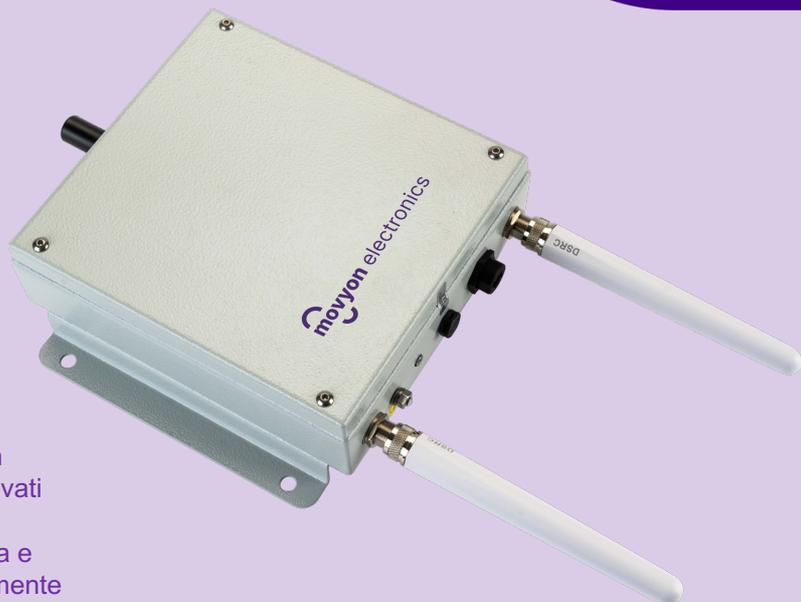
La Road Side Unit C-ITS V2X abilita la comunicazione wireless bidirezionale tra l'infrastruttura stradale e la On Board Unit (OBU) presente nel veicolo, assicurando elevati livelli di sicurezza e affidabilità nello scambio dei dati. Consente un monitoraggio evoluto degli eventi su strada e una gestione efficiente del traffico. La soluzione, interamente sviluppata e prodotta da Movyon Electronics, è personalizzabile in base alle esigenze del cliente.
